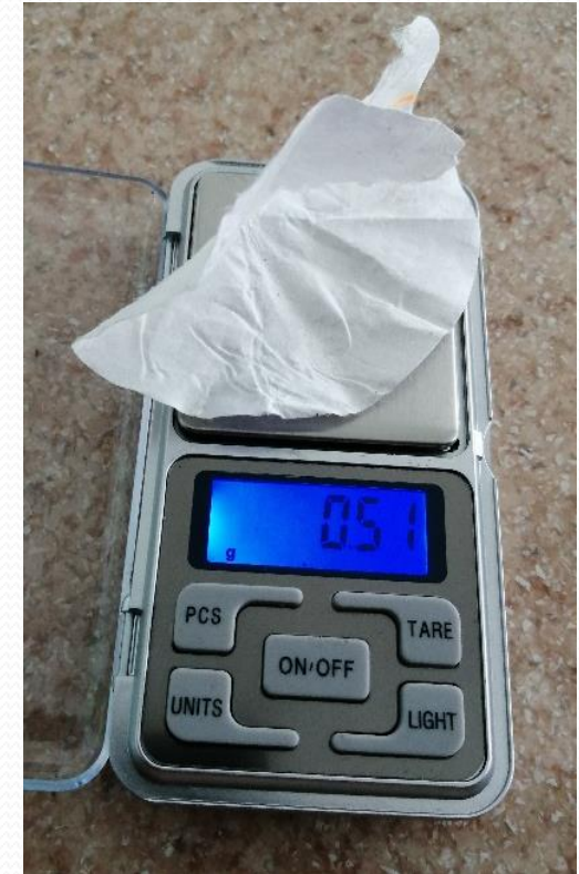
Взвешивание фильтров до фильтрации и после высушивания
