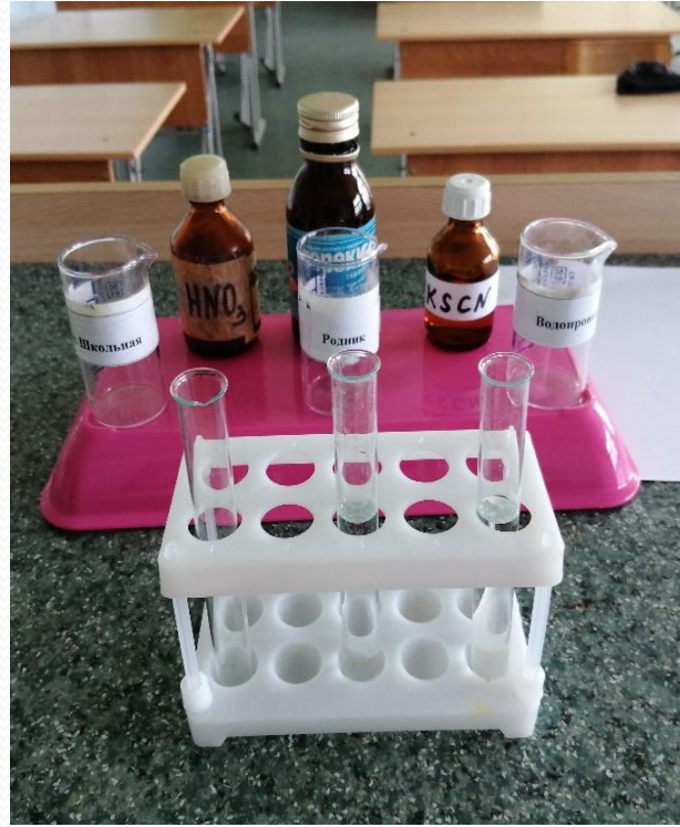
Химические реактивы для обнаружения железа
