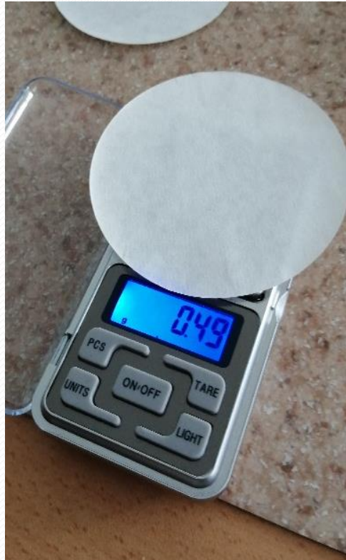
Взвешивание фильтров до фильтрации и после высушивания
